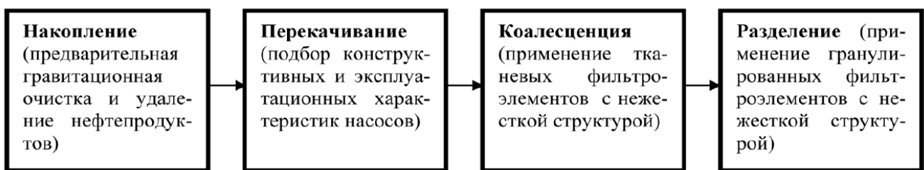
Рисунок 2 - Технологическая схема системы очистки НСВ
