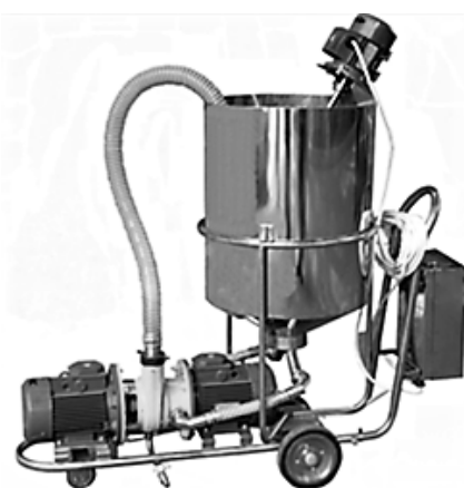
Рисунок 3 – Установка кавитационной обработки дрожжевой массы для приготовления автолизатов.
