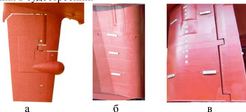
Рисунок 1 – Типовые проектные решения, применяемые в судостроении: а – бульбобразная наделка пера руля [1], б - плавники концевое перетекания потока [1], в – рулевая плоскость с закрылком [2]
