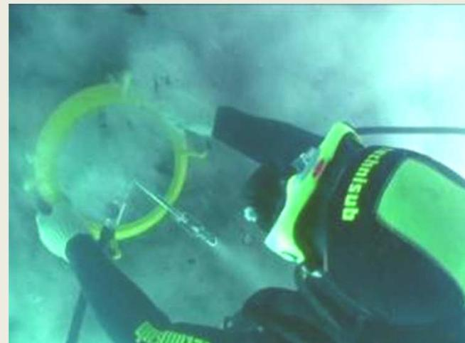
Вид на один из вариантов ротационного водолазного инструмента «Скат –НЕО» и работа под водой
