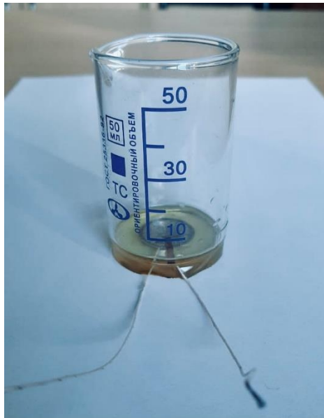
Рисунок 1 – Стакан с приклеенным снаружи ко дну пьезоактуатором
