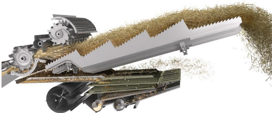
Рисунок 1 – 3-D модель очистки ЗУК
