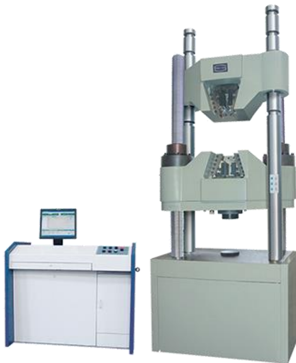
Рисунок 1 – Универсальная испытательная машина с компьютерным управлением TIMEWAW–500С ( https://ndtesting.ru/wa-data/public/shop/products/12/29/2912/images/554/554.200x0.jpg )
