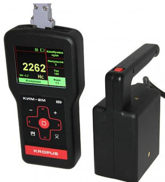
Рисунок 4 – Портативный коэрцитиметр КИМ-2М ( https://ecnk.ru/upload/resize_cache/iblock/d28/500_500_1/d288af3854339c30b44fc9eec20cc2c7.jpg )
