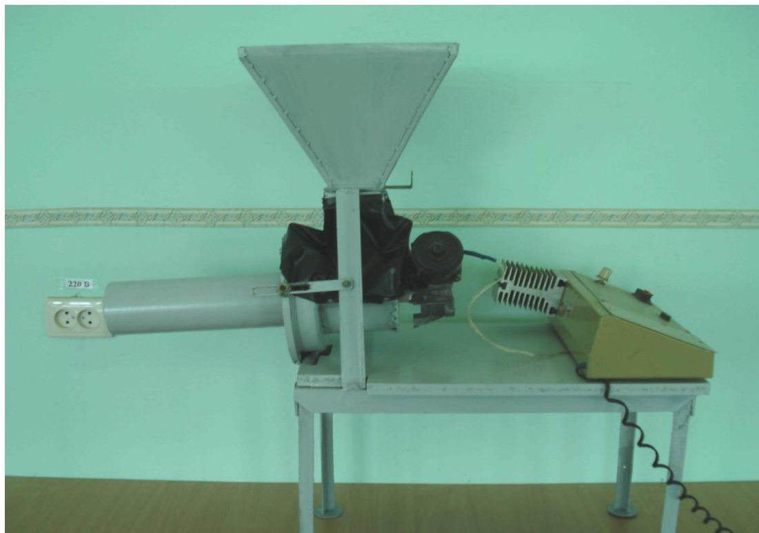
Рисунок 2 – Фото экспериментальной установки дозатора непрерывного действия с цилиндрическим рабочим органом без внутренних устройств
