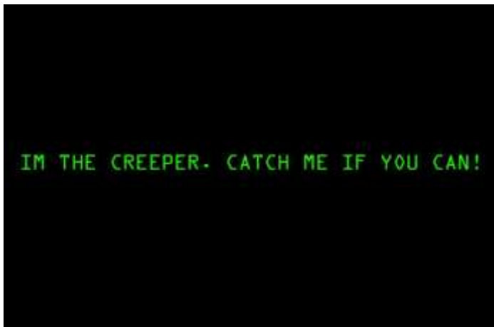
Рисунок 1 – Результат действия первой вредоносной программы Creeper
