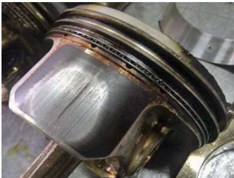
Рисунок 1 – Задир на юбке поршня
