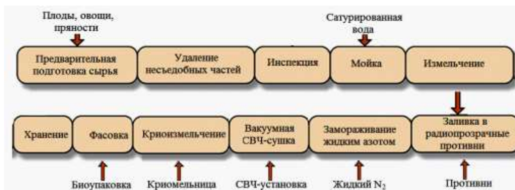
Рисунок 1 – Структурная схема производства плодоовощных криопорошков
