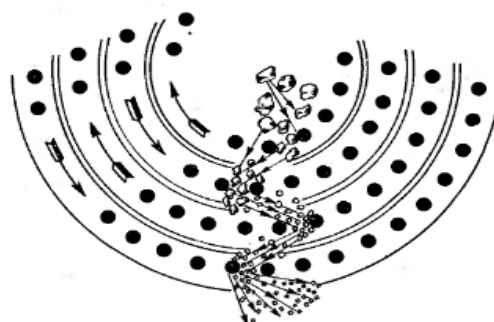
Рисунок 2 – Схема движения материала в дезинтеграторе
