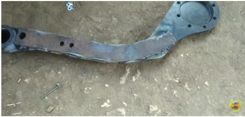
Рисунок 6 – Ремонт рычага в полевых условиях
