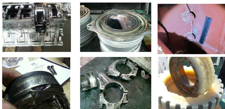
Рисунок 2 – Неисправности ПК с ЧПВ
