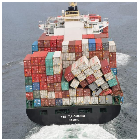
Рисунок 1 – Завалившийся ряд контейнеров
