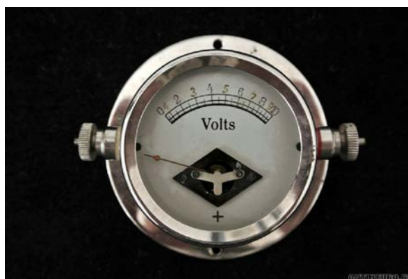
Рисунок 7 – Старинный вольтметр (Европа). Материал – немагнитная сталь
