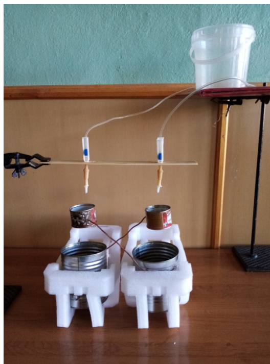
Рисунок 3 – Рабочий образец капельницы Кельвина
