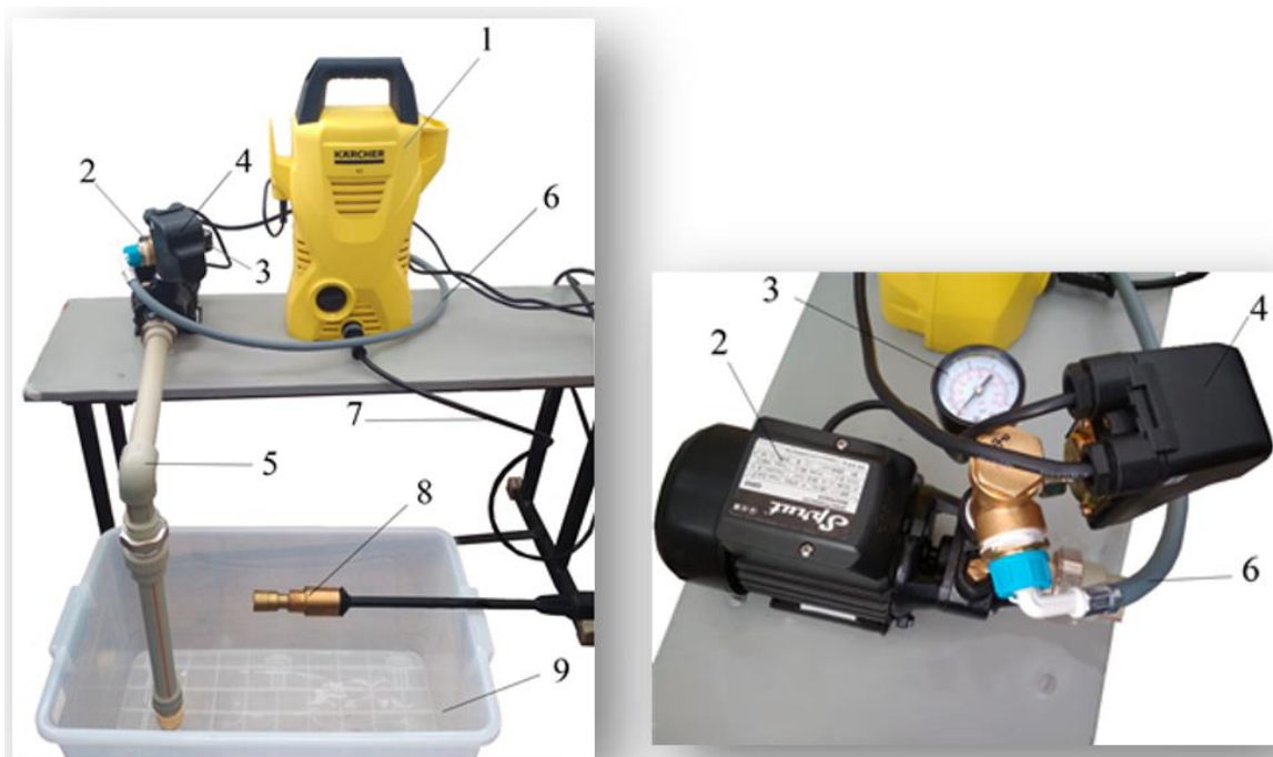
Рисунок 2 – Схема экспериментальной установки: 1 – Karcher k2 соплас; 2 – Электронасос Sprut QB; 3 – Манометр радиальный Y-50-6; 4 – Реле давления PS-II-15 10 А; 5 – Трубы для подачи жидкости на вход центробежного насоса; 6 – Соединительный шланг; 7 – Шланг высокого давления; 8 – Переходник с кавитатором; 9 – Емкости для жидкости
