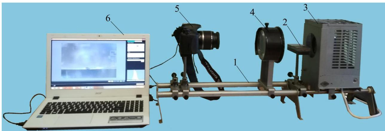
Рисунок 2 – Экспериментальная установка для определения краевого угла капли
