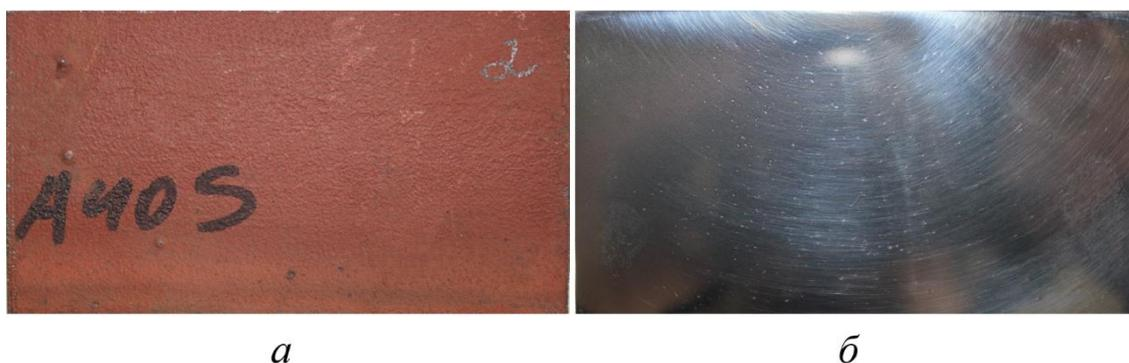
Рисунок 1 – Поверхность экспериментальных образцов после проката (а) и полировки (б)
