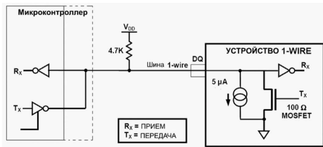
Рисунок 4 – Схема аппаратной реализации интерфейса 1 – Wire.
