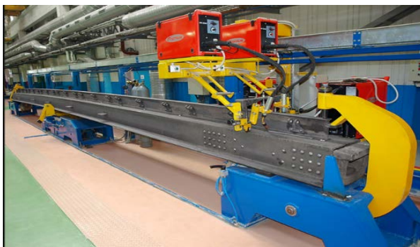
Рисунок 1 - Стен для автоматической сварки балок
