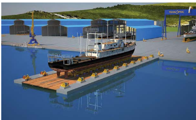
Рисунок 6 - Вертикальный судоподъемник с продольной накаткой объекта
