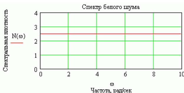
Рисунок 6 – Энергетический спектр (спектральная плотность) белого шума. Спектральная плотность на всех частотах одинакова
