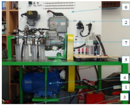
Рисунок 1 - Испытательный стенд для тестирования системы СУДГА (1 аккумулятор, 2 контроллер, 3 топливных бака, 4 привода насоса, 5-ступенчатая система управления, 6 элементы электронного управления, 7 впрыскивающих насосов и топливный инжектор)
