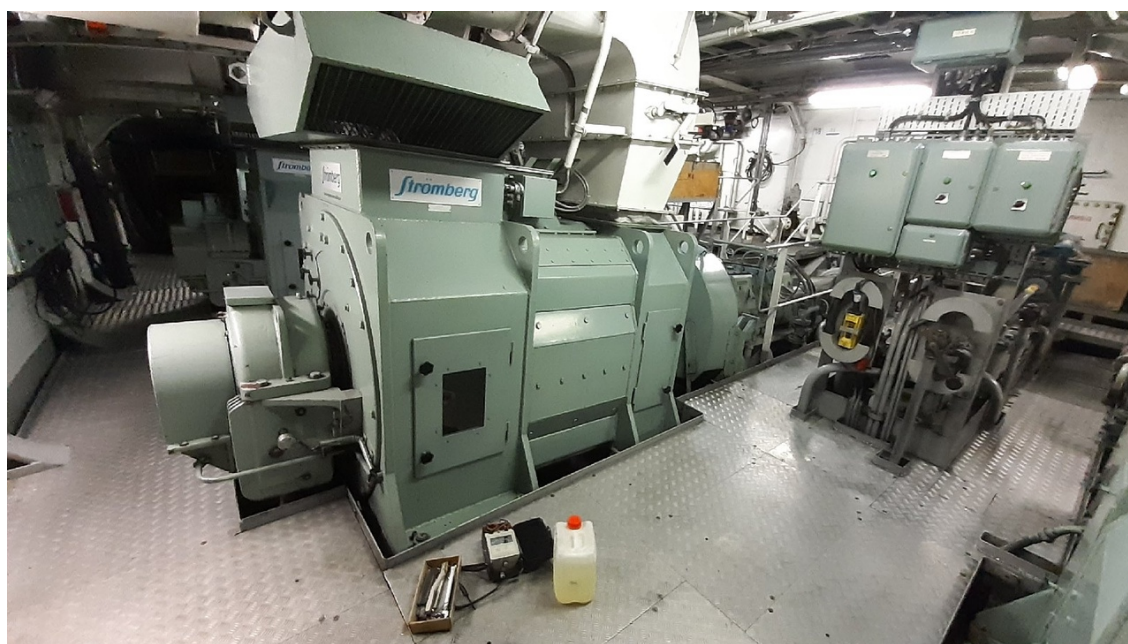
Рисунок 1 – Гребной электродвигатель Stremberg 100/714 M1105
