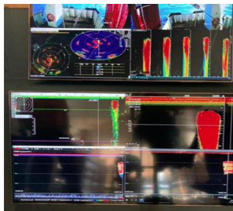
Рисунок 2 - Система контроля трала (гидролокатор, видеокамеры кормовые)
