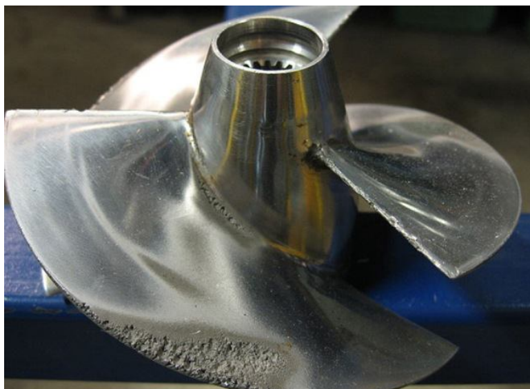
Рисунок 1 – Кавитационное разрушение поверхности винта
