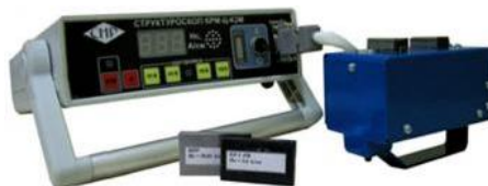
Рисунок 4 – Общий вид коэрцитиметра КРМ-Ц-К2М с датчиком. https://priborpostavka.ru/files/styles/preview/public/device/krm-c-k2m.jpg?itok=nJ_kQmUm
