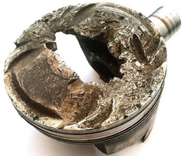
Рисунок 2 – Последствия детонации бензинового двигателя
