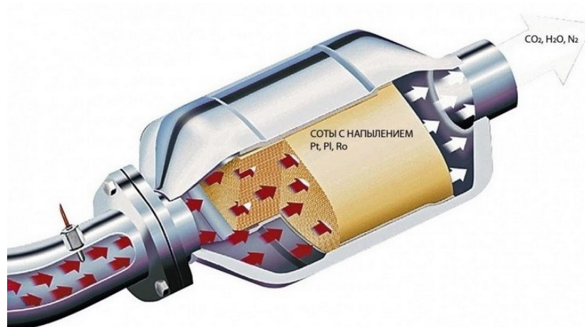
Рисунок 1 – Каталитический нейтрализатор отработавших газов
