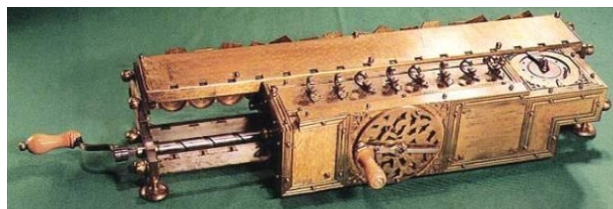
Рисунок 7 – Ступенчатый вычислитель Г. Лейбница (реконструкция)
