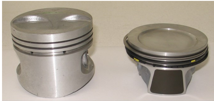
Рисунок 2 – Поршень старого «ведерного» и нового Т-образного типа
