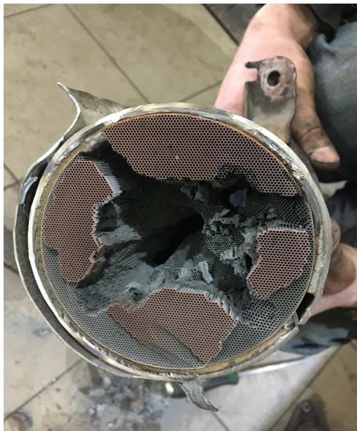
Рисунок 3 – Разрушающиеся керамические соты НК
