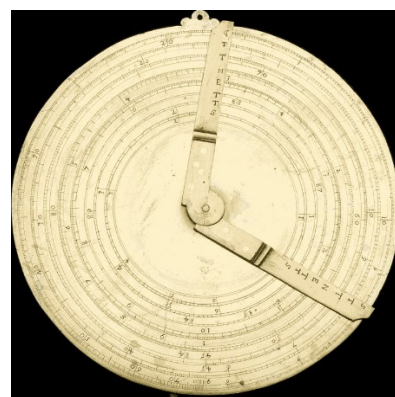
Рисунок 4 – Круговая логарифмическая линейка У. Отреда
