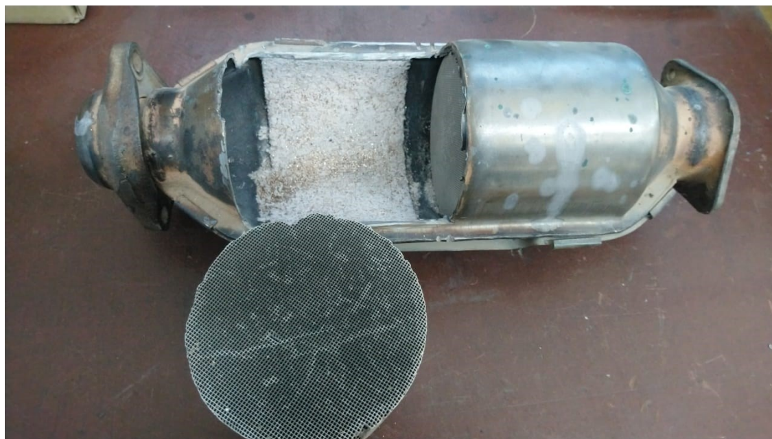
Рисунок 4 – Катализатор, состоящий из двух «блинчиков» с промежутком
