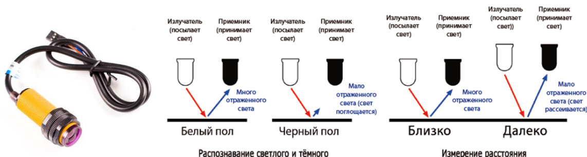
Рисунок 3 – Инфракрасный дальномер и его принцип работы
