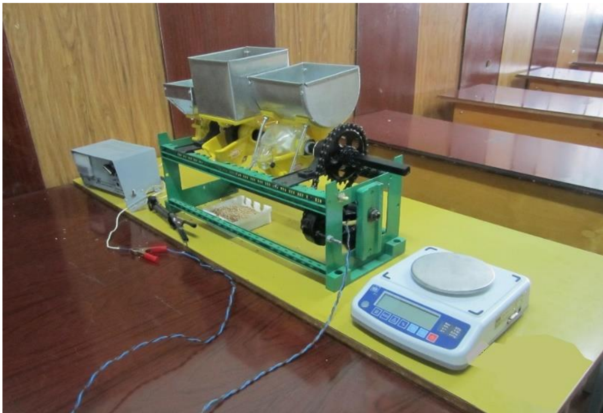
Рисунок 2 – Лабораторная установка для проверки производительности механических высевальных систем катушечного типа.
