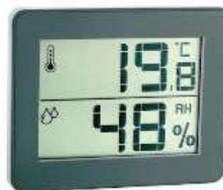
**Рисунок 9 – Электронный гигрометр**
