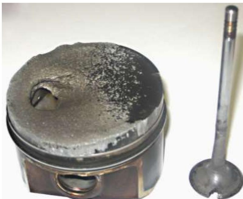
**Рисунок 1 – Последствия детонации в бензиновом ДВС**
