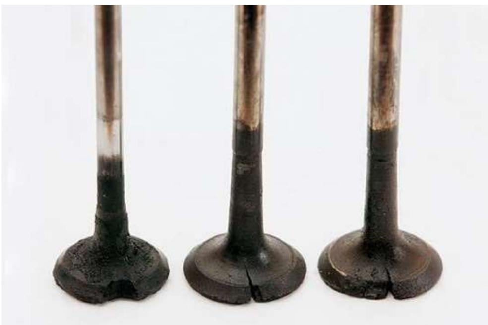
**Рисунок 1 – Прогоревшие неотрегулированные клапана ДВС на газе**
