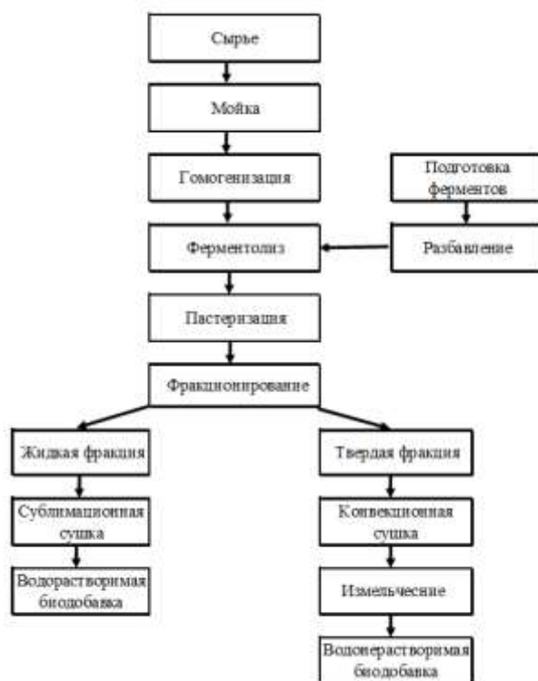
Рисунок 1 – Технологическая схема переработки некондиционных ФРОВ
