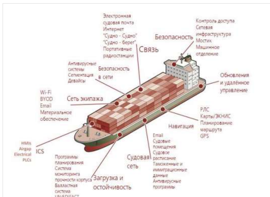
Рисунок 1 – Потенциально уязвимые для взлома компоненты судовых систем
