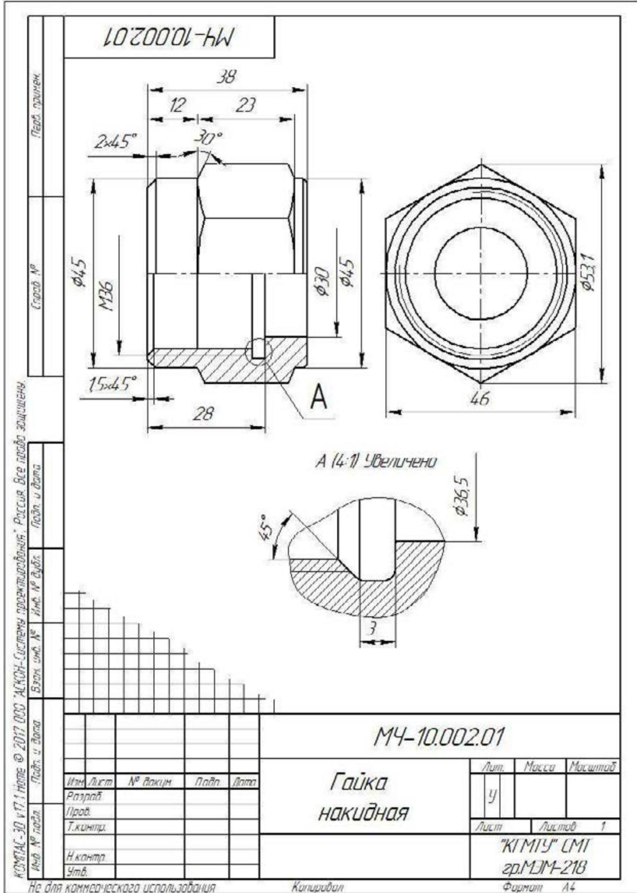
Образец выполнения эскиза детали гайка накидная
