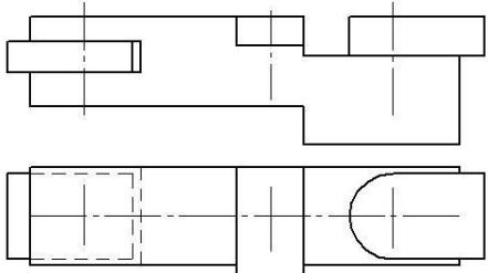
Перечертить изображение деталей в масштабе 2:1. Изобразить упрощенно по ГОСТ 2.315-68 соединение деталей болтом, винтом и шпилькой. Крепежные изделия чертить в масштабе 1:1.
