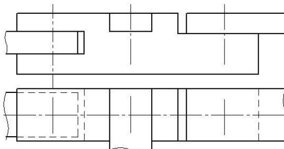
Перечертить изображение деталей в масштабе 2:1. Изобразить упрощенно по ГОСТ 2.315-68 соединение деталей болтом, винтом, шпилькой. Крепежные изделия чертить в масштабе 1:1.
