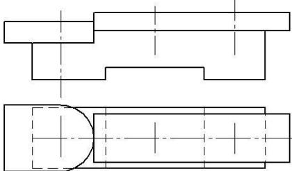
Перечертить изображение деталей в масштабе 2:1. Изобразить упрощенно по ГОСТ 2.315-68 соединение деталей болтом, винтом и шпилькой. Крепежные изделия чертить в масштабе 1:1.
