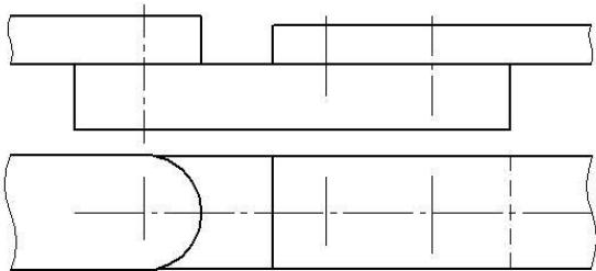
Перечертить изображение деталей в масштабе 2:1. Изобразить упрощенно по ГОСТ 2.315-68 соединение деталей болтом, винтом, шпилькой. Крепежные изделия чертить в масштабе 1:1.
