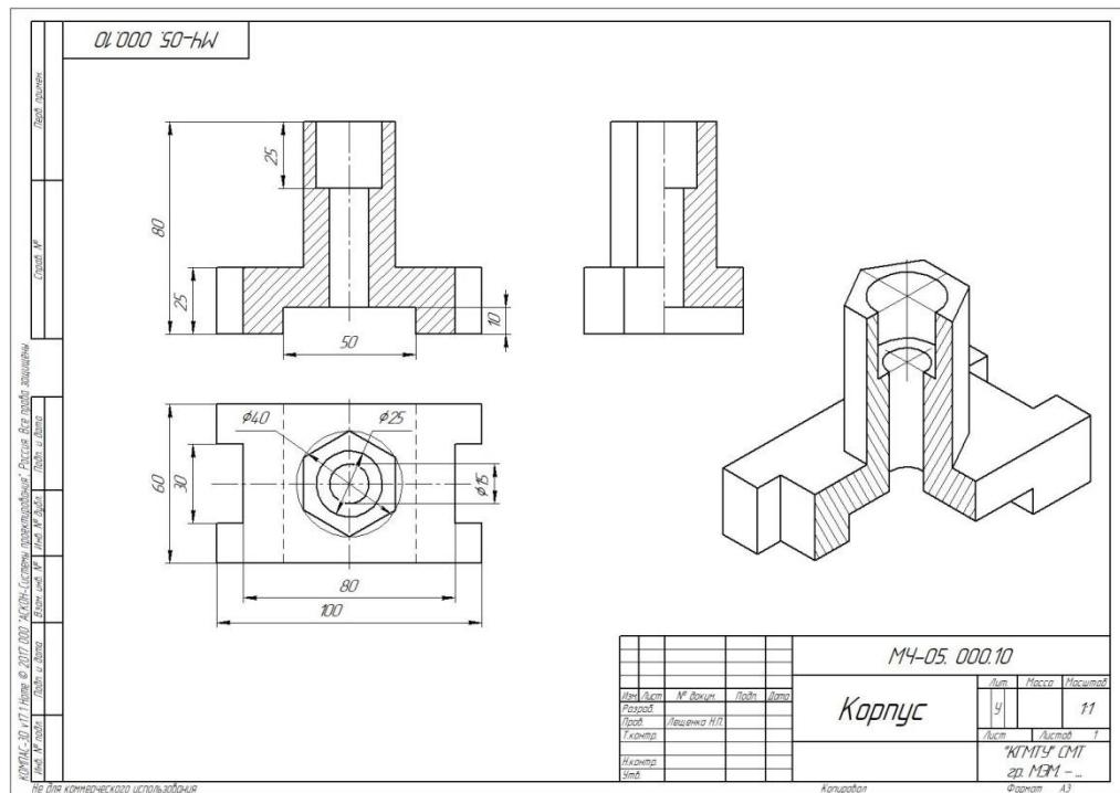
21.1 Изображение детали, расположенное на чертеже в правом нижнем углу, является \_\_\_\_\_ проекцией (выберите один вариант ответа)
