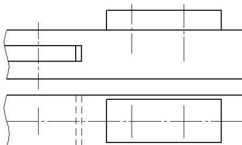
Перечертить изображение деталей в масштабе 2:1. Изобразить упрощенно по ГОСТ 2.315-68 соединение деталей болтом, винтом и шпилькой. Крепежные изделия чертить в масштабе 1:1.
