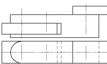
Перечертить изображения деталей в масштабе 2:1. Изобразить упрощенно по ГОСТ 2.315-68 соединение деталей болтом, винтом, шпилькой. Крепежные изделия чертить в масштабе 1:1.
